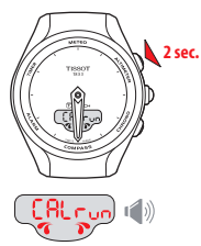
Aktivace režimu kalibrace – deaktivace skřípka během kalibrace
