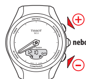
⊕: zvýšení o 1 hodinu ⊖: snížení o 1 hodinu
